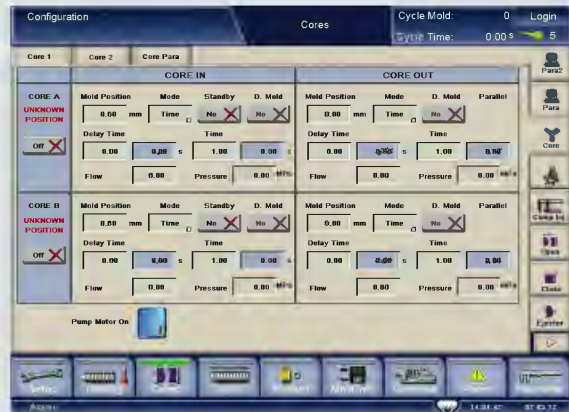
Regolazione pressione e velocità delle estrazioni radiali idrauliche a video.
